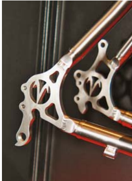
Zpracování titanu není úplně jednoduché, řezání patek vodním paprskem však umožňuje i realizaci téměř umělečeských děl. Estetika s nízkou hmotností se nejednou vzájemně prolínají.
