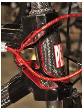
Kombinace materiálů umožňuje konstruktérům vymýšlet zajímavé variace na téma „rám“. Všimněte si také sestavy duralových válečků nahrazujících klasické bowdeny.
