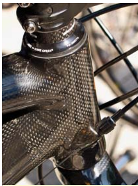
V případě karbonového rámu je možné pracovat i s řadou detailů, například s integrovanou opěrkou pro bowden.
